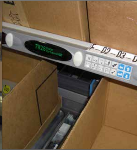
Indicadores Pick-to-Light con tecnología LED
